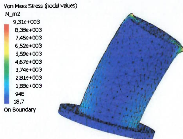
Figura 7.1.1.4- Simulação de tensão PIN.STEP no CATIA
